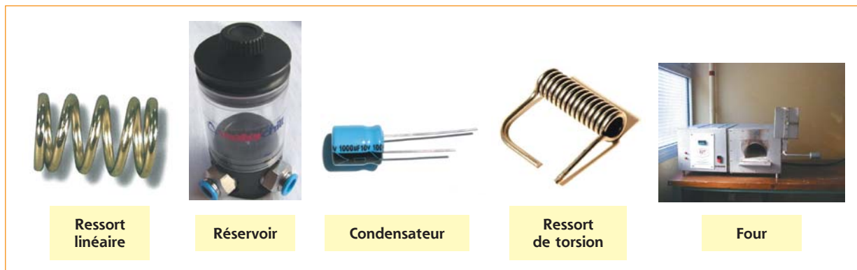
Figure 8 : éléments de stockage d'énergie potentielle
